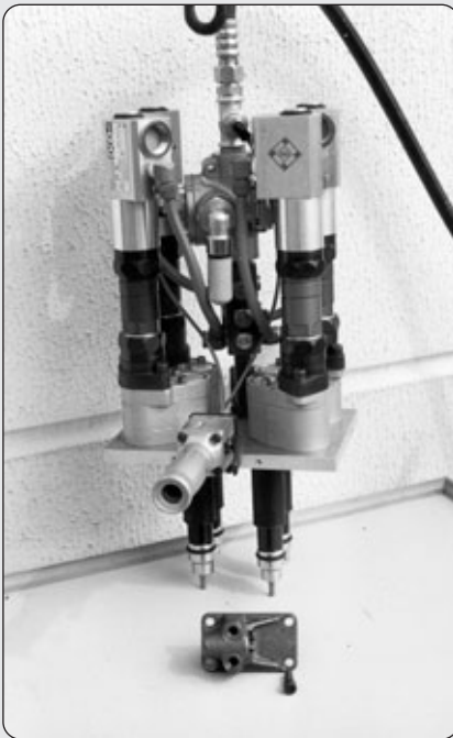
Handgeführter 4fach-Schrauber mit Druckluft-Abschalterschraubspindeln. Balancer-Aufhängung.
