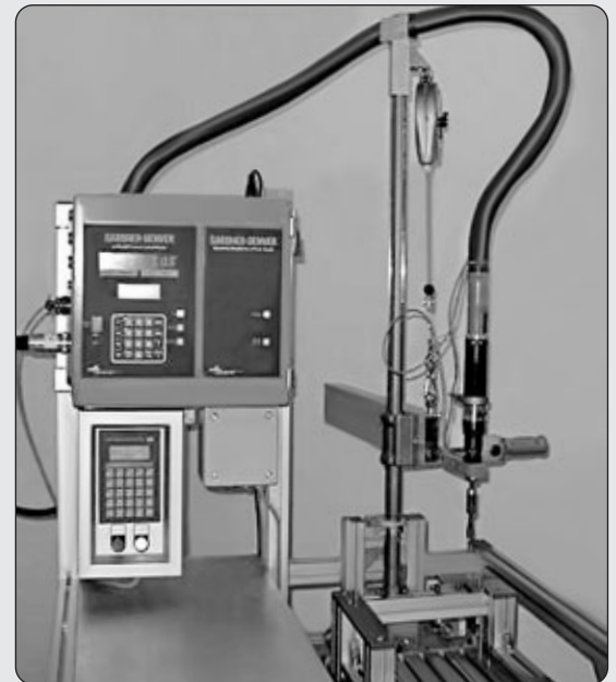
Schraubvorrichtung ausgerüstet mit einer elektronisch gesteuerten Schraubspindel. SPS-Steuerung zur Positionsbestimmung. Der Schrauber wird über ein Linearstativ von Hand positioniert, die SPS gibt den Schrauber nur frei, wenn die vorgegebene Position erreicht ist.
