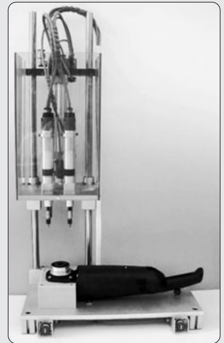
4fach-Stativschrauber mit Druckluft-Abschalterschraubspindeln. Vorschub pneumatisch.
